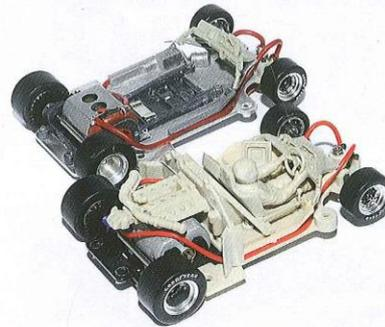
Au premier plan, châssis en ABS de la Rondeau 1981 et derrière, le châssis en alu de la version 1980. Souci du détail extrême : les tableaux de bord sont différents !
