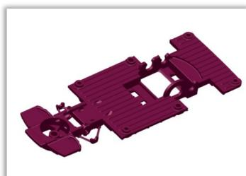
Châssis racing imprimé en 3D pour transformer le modèle statique en modèle roulant.
