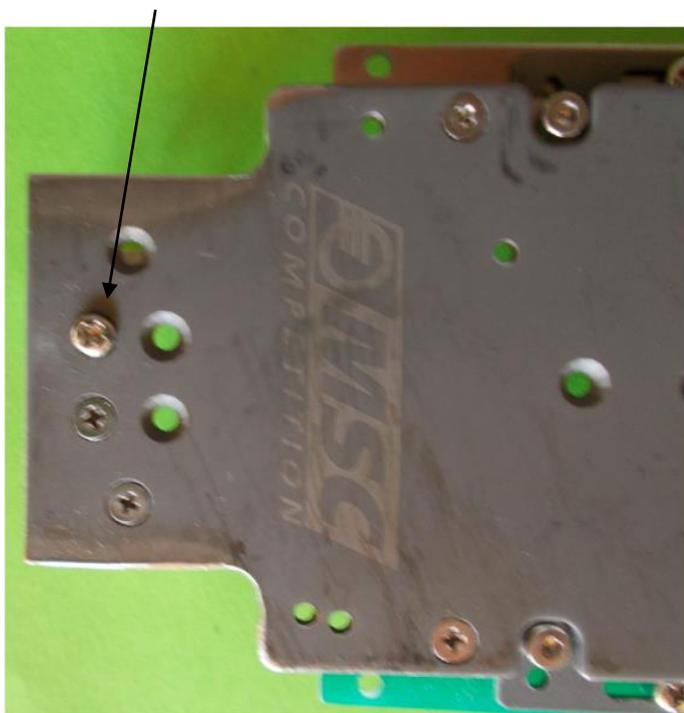
Châssis terminé : mise en place du moteur, avec ses supports d'origine sans modification, mais en les positionnant au plus près de l'axe arrière.
